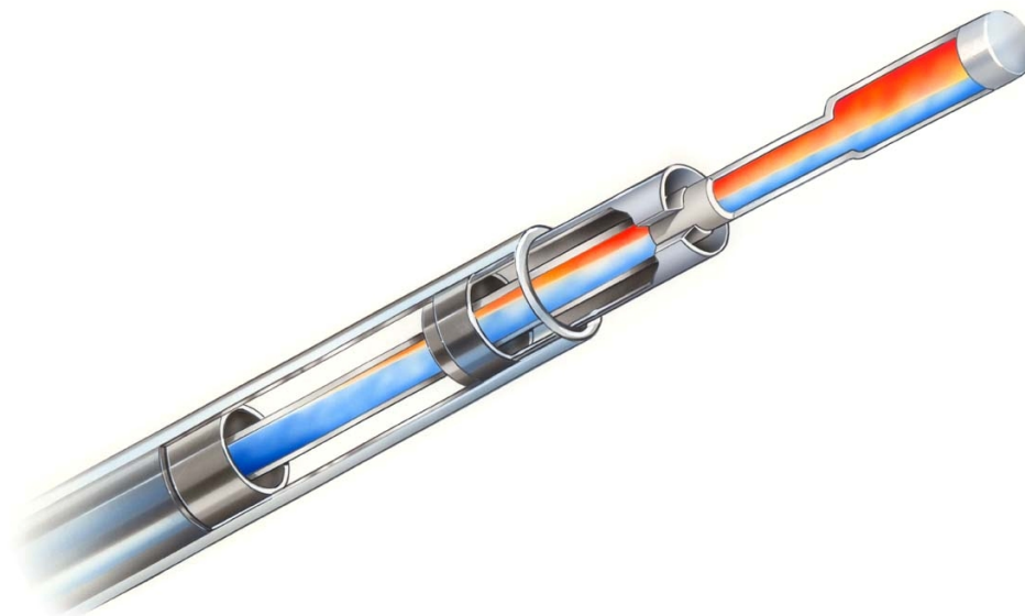
Vakuurröhre mit Heatpipe und Aluminiumstreifen
